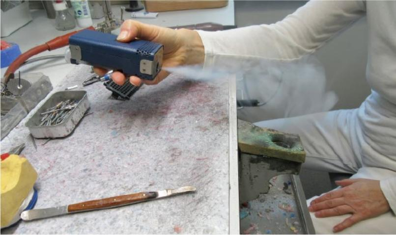
► 7 Ohne Absaugmaul ist keine effektive Absaugung des Staubs mehr gewährleistet. Der Nebel wabert über der Erfassungsoffnung.
